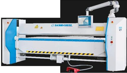
Sehr rascher Biegeablauf durch dynamisches Verfahren von 5 Maschinen-Positionen
