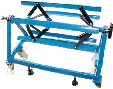
Spreizdorn mit 5 Aufnahmetraversen, Kanten abgerundet und Bremse, beide Seiten kugelgelagert.
