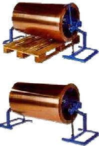
zur Bestückung ohne Kran / Stapler, Freistellung von Palette über Handspindel. Spreizdorn mit 5 Aufnahmetraversen, Kanten abgerundet und Bremse, beide Seiten kugelgelagert.
