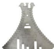
rostfreier, gehärteter Edelstahl, blank poliert, von 5 - 200 mm, alle 5 mm steigend. Inklusiv aller Falz-Biegepunkte
