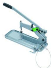
Schwere Ganzstahl- Ausführung. Mit Einhängenvorrichtung in die Dachlatte. Bricht alle Arten von Dachziegeln und Biberschwanzziegeln in die gewünschte Form.
